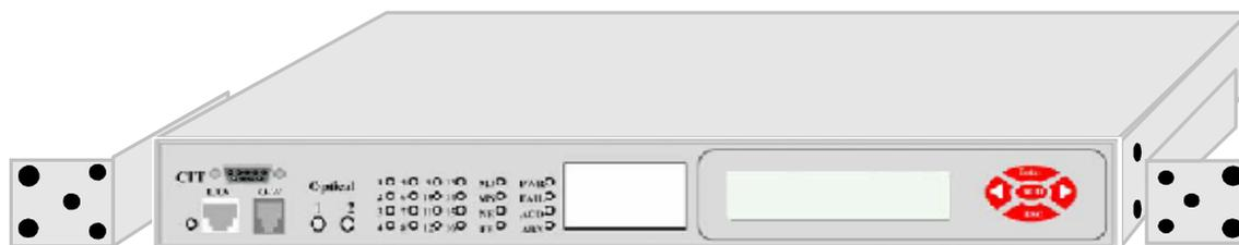
Рис 3.1б. Установка в стойку 19”.
